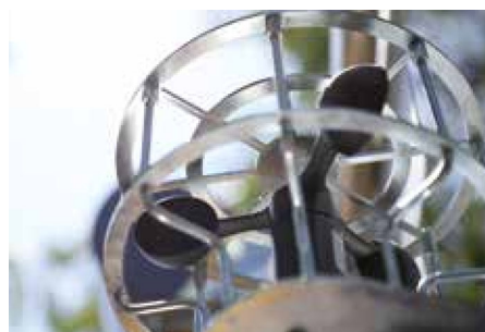
Windmesser (optional) Zur Kontrolle und Abgabe von Warnmeldungen vor Erreichen der maximal zulässigen Windgeschwindigkeit (45 km / h)
