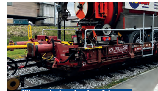
Wagon à plancher bas Scdmrs
